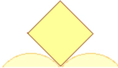
FIG. 2 – En une jonction, les tangentes aux arcades doivent faire un angle égal aux angles aux sommets de la roue.
